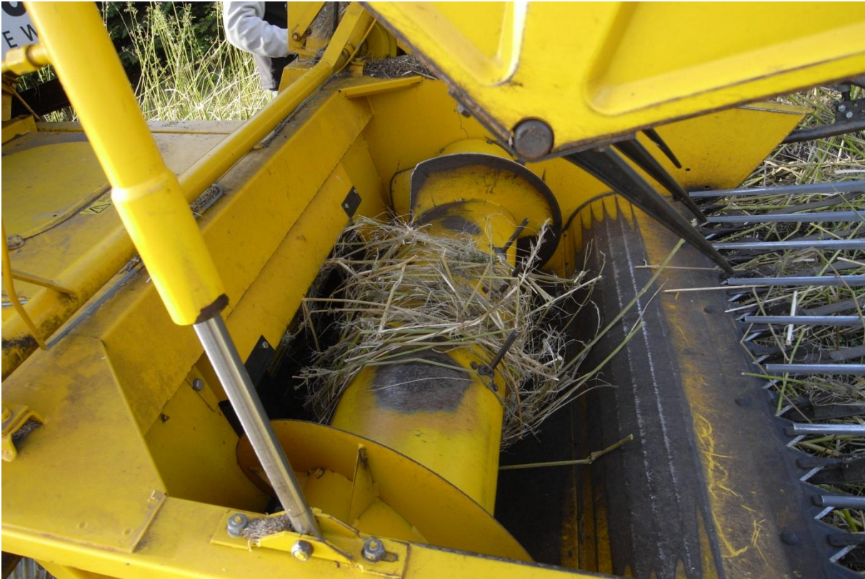
Foto 15. Det vil være en fordel, hvis flere af piggene på indføringstromlen afmonteres før høst af hamp. Fotograf: Lars Egelund Olsen, Videncentret for Landbrug.
